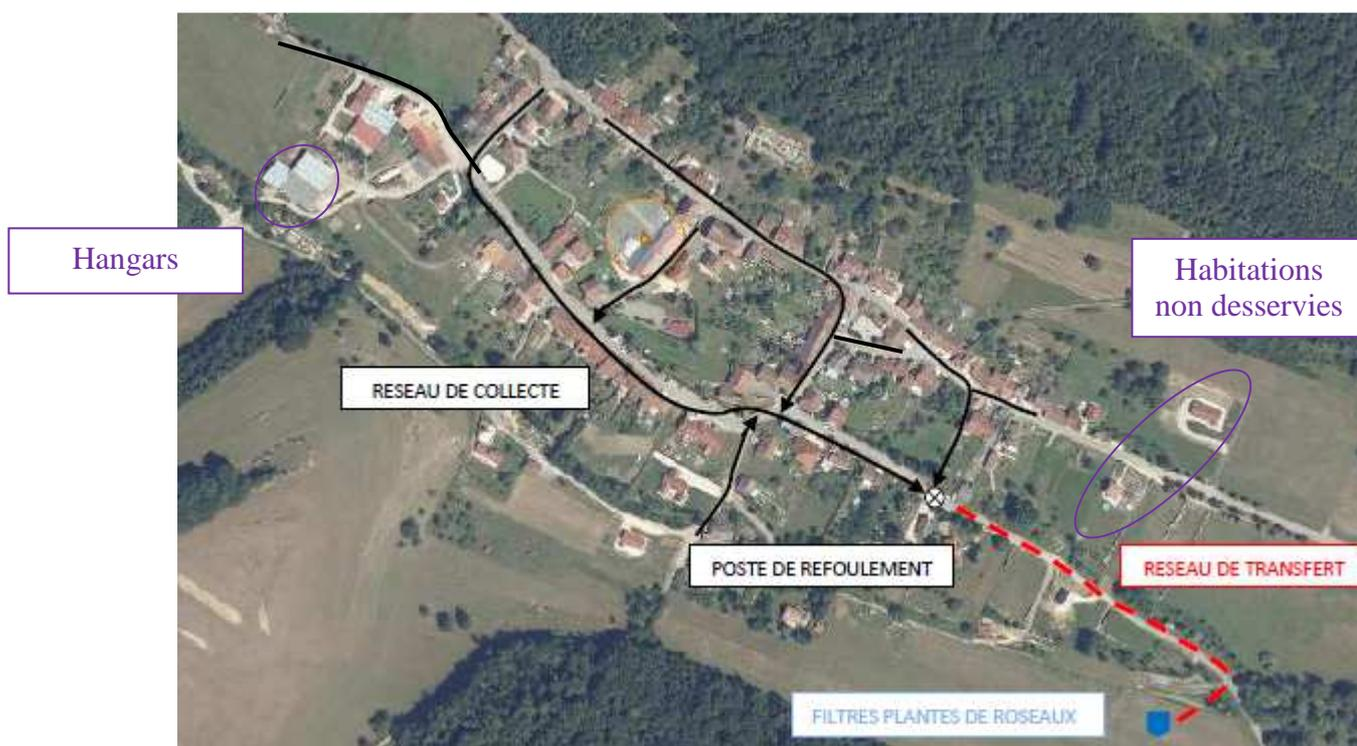
Figure 18 : tracé schématique des réseaux existants
